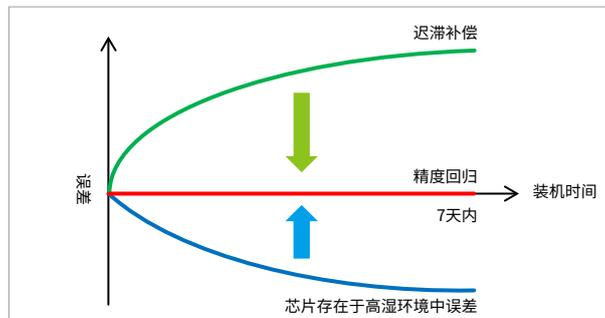
低露点温度应用时，由于连续干燥芯片可能造成量测值如蓝色曲线造成使用初期精度未达产品标准。物体藉由绿色曲线的补偿(迟滞补偿)缓解，使安装初期也可达到产品精度标准。
