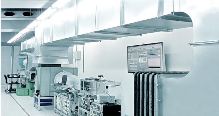
风洞校正系统可提供校正时的标准化稳定环境，并且在运行中不受外界因素干扰，再搭配自动化检测系统，大幅提升风速产品校正后的精确度与可靠性。此风洞系统遵循ISO/IEC 17025的运作标准，可另行加购校正报告。
