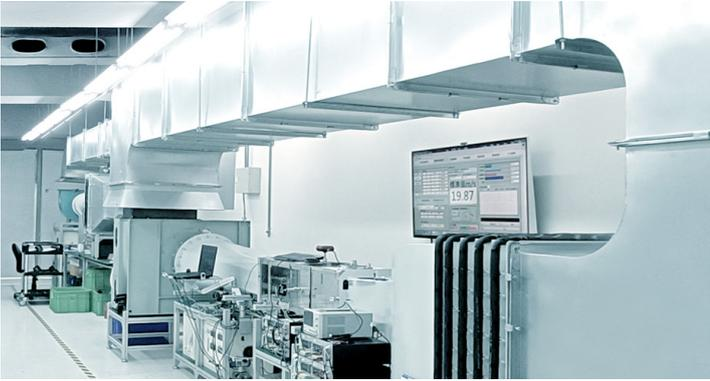
风洞校正系统可提供校正时的标准化稳定环境，并且在运行中不受外界因素干扰，再搭配自动化检测系统，大幅提升风速产品校正后的精确度与可靠性。此风洞系统遵循ISO/IEC 17025的运作标准，可另行加购校正报告。
