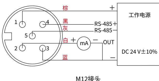
\*请确认产品与连接RS-485之仪器共地，避免接地电压差造成损害。
